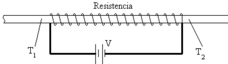
El calentador está formado por una resistencia de  $(1\Omega)$  y una fuente de tensión.
