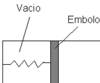
La sección del tubo es de  $(3\text{cm}^2)$  y la longitud natural del resorte es 10 cm. El rozamiento del embolo se considera despreciable.
